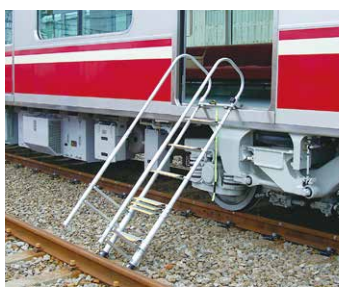
▲ 非常脱出ハシゴを設置した様子
