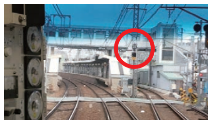
▲神奈川新町第1踏切道(下り線)に対する発光信号機の増設等
