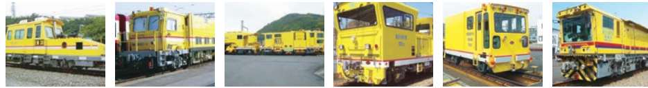
軌道検測車「EM30」 軌間、水準、高低、通り、平面性を検測します。 マルチプルタイタンパー「08-16U」 軌道の保守（軌道の高低、通り、水準）をする作業車です。 バラストフィニッシャー「802B号車」 マルチプルタイタンパー作業後の軌道整備時に活躍します。 モーターカー「105D号車」 ダンプトロリなどを牽引し、レールや砕石を運搬します。 遠隔制御車「RC701C号車」 道床砕石や残土を積載し、低床トロリの端部で活躍します。 レール削正車「RG301」 レール頭部の形状を適切に保つため、レール頭部を削る作業車です。
